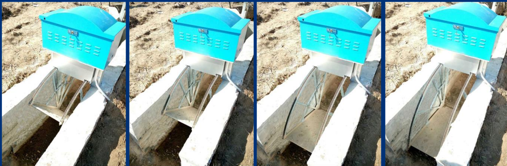
(a) 完全关闭状态 (b) 开始溢流状态 (c) 进一步溢流状态 (d) 水平状态
